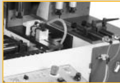
Spanneinrichtungen vertikal und horizontal jeweils beidseitig des Sägeblattes
