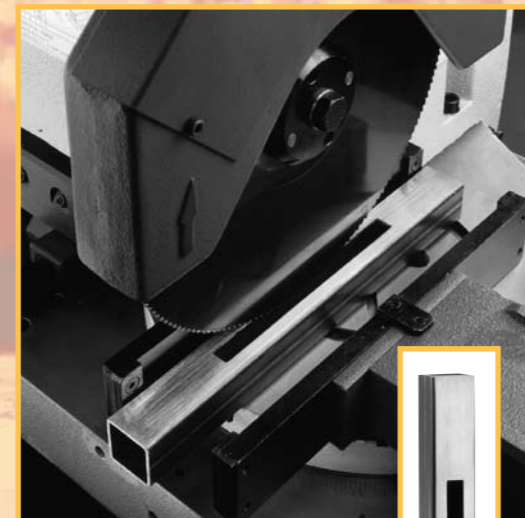
Anwendungsbeispiel: Schlitzen von Profilen (z.B. zum Einlassen von Türschlossern)
